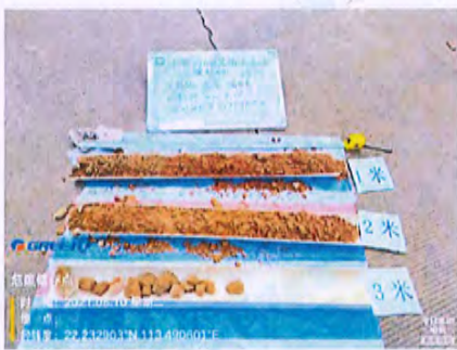
危化品仓库的危废储存点(危废 储存点)土壤采样点
