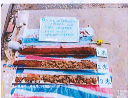
三期污水处理站土壤采样点
